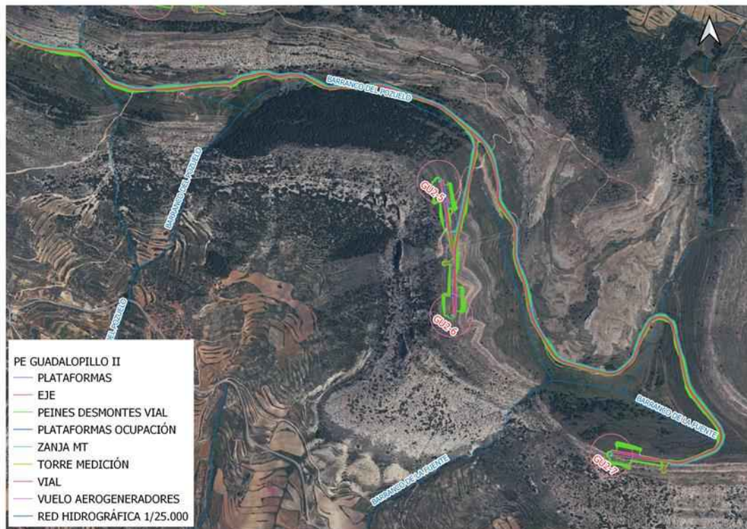
Imagen del cruce de los viales de acceso a los aerogeneradores y zanjas con Barranco de la Fuente y Barranco del Pozuelo en el ámbito medio de estudio.E:1/25.00. Fuente: propia
